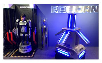
路邦團隊結合5G、人工智能、機器學習、物聯網及雲端計算科技開發出機械人Unicorn,全身安裝多個紫外線燈,發出與醫院手術室常見、屬短波的紫外線UV-C用以殺菌消毒。Unicorn更動用了路邦目前最強勁的移動系統設計,其特製輪子移動性強,可在任何室內外平面甚至斜坡上行走,因此可輕鬆高效地消毒醫療場所例如病房、重症監護室;物業管理場所如貨梯、廁所和垃圾房等高危地方。當Unicorn接收到遙距指示移動到指定地點,機械人側翼更可靈活展開,全面覆蓋消毒範圍;同時配備360°鏡頭,讓遙距操作者視乎需要以UV-C照射個別地點多點時間,令消毒更徹底。
